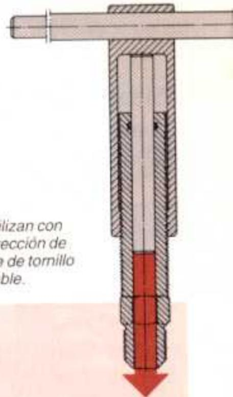
Para los usuarios que no utilizan con frecuencia el método de inyección de aceite, un inyector de aceite de tornillo es una herramienta manejable.
