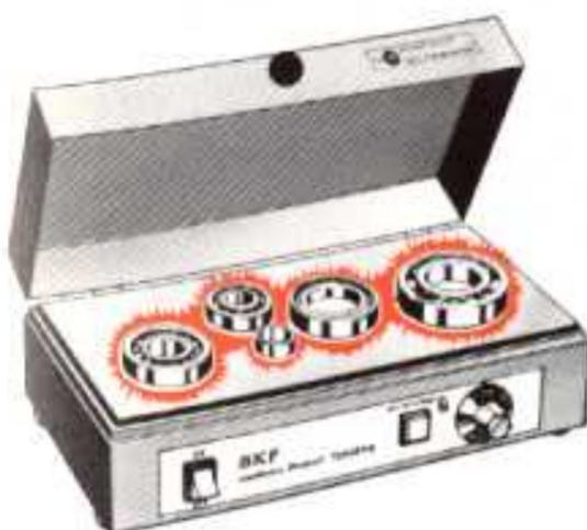
Para calentar pequeños rodamientos se puede utilizar una placa caliente eléctrica, equipada con un termostato regulable y una tapa. En esta placa se pueden calentar varios rodamientos pequeños simultáneamente, y pueden mantenerse calientes hasta que se vaya a realizar su montaje.
