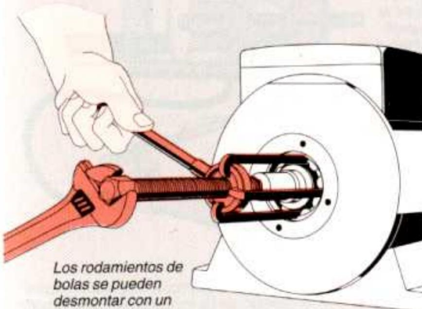
*Los rodamientos de bolas se pueden desmontar con un extractor especial.*
