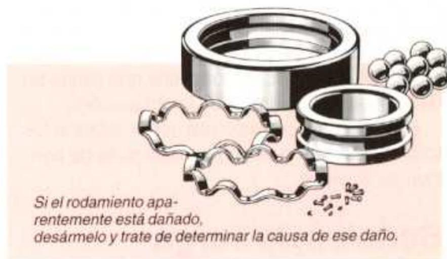
utilizar nuevamente. Utilice un pequeño espejo y una sonda similar a la que usan los dentistas (con su extremo redondeado) para inspeccionar los caminos de rodadura, la jaula y los elementos rodantes.
