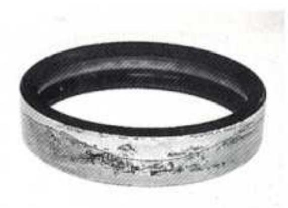
**Grietas causadas por corrosión por contacto**
