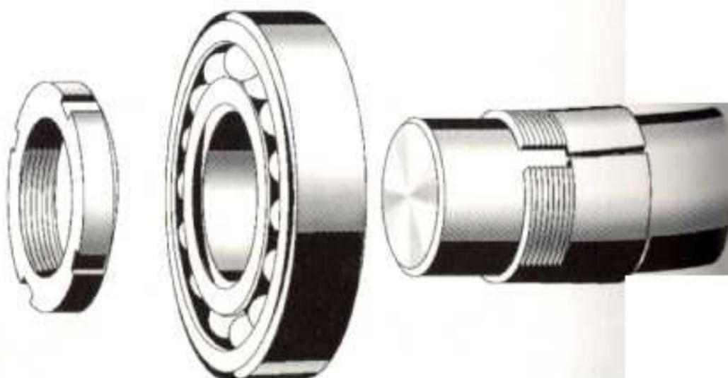
*Coloque el rodamiento en el manguito y rosque la tuerca con el chaffán hacia el rodamiento. Apriete la tuerca justo lo suficiente para asegurar que el rodamiento y el eje hagan contacto con el manguito, pero no apriete más el rodamiento de forma que se pudiera calar sobre el manguito.*
