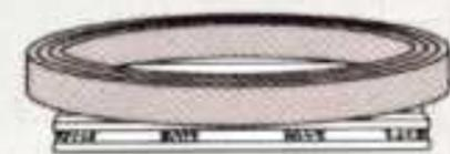
Si se va a utilizar nuevamente un rodamiento, deberá almacenarse en posición horizontal.
