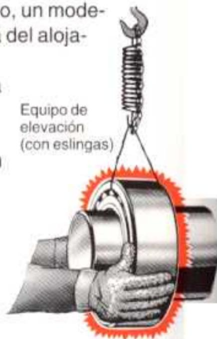
Utilice guantes protectores limpios para sujetar con las manos los rodamientos calientes. Presione con fuerza contra la cara de soporte de forma que el aro interior quede completamente apretado en el apoyo.
