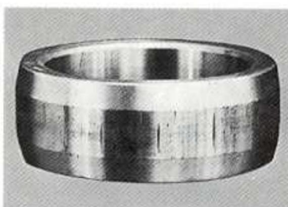
**Desconchado causada por el desgaste**
