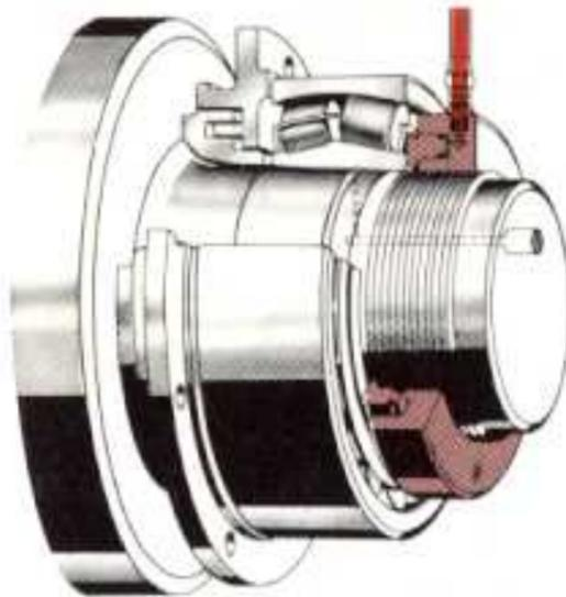
Con una tuerca hidráulica se pueden montar rodamientos con un diámetro de agujero de hasta 1 000 mm. Dote al eje de ranuras y un conducto para el desmontaje con inyección de aceite.
