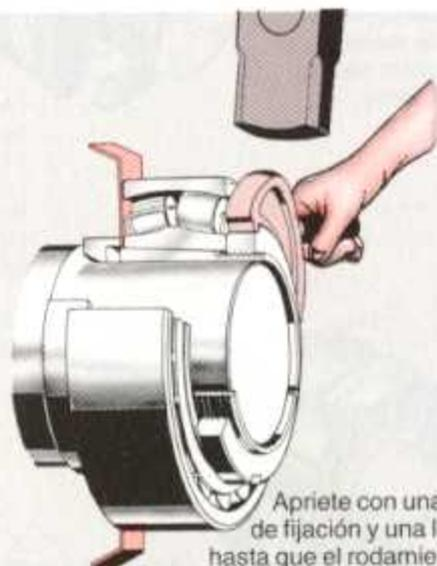
Apriete con una tuerca de fijación y una llave hasta que el rodamiento comience a presionar las arandelas de reglaje. Quite las arandelas y apriete la tuerca al calado axial previamente determinado. Compruebe el juego interno.
