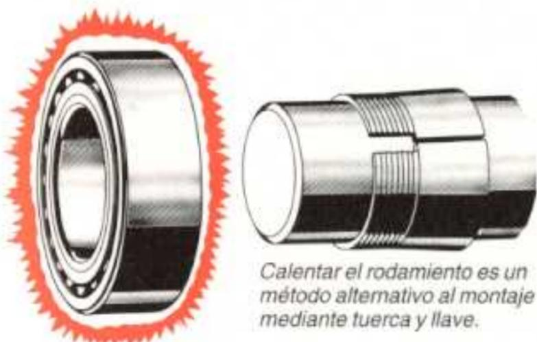
Calentar el rodamiento es un método alternativo al montaje mediante tuerca y llave.
