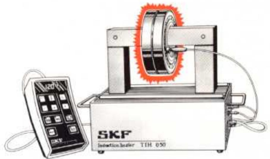
Un calentador de inducción con desmagnetización automática de SKF puede calentar de forma segura rodamientos de tamaños pequeños y medios que hayan de montarse con un ajuste de interferencia en el eje.
