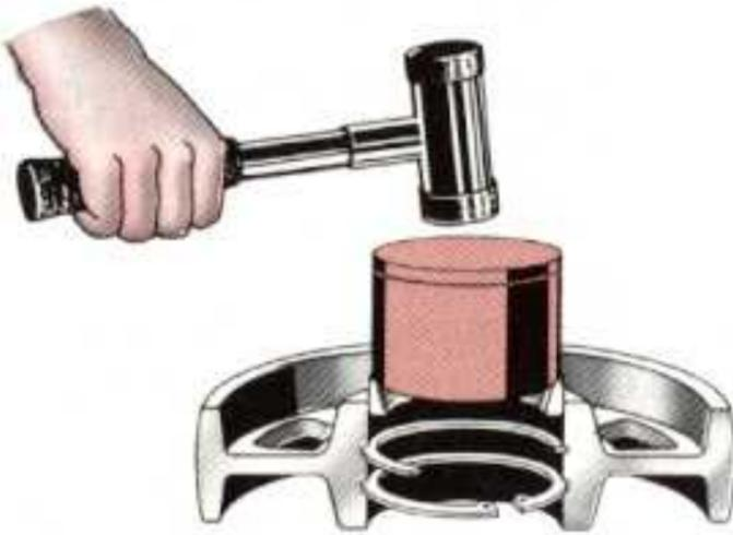
Los dos aros exteriores se montan en frío por medio de un casquillo de montaje y unos golpes de martillo. Deben introducirse en el cubo de la rueda hasta que presionen con fuerza contra el resalte.
