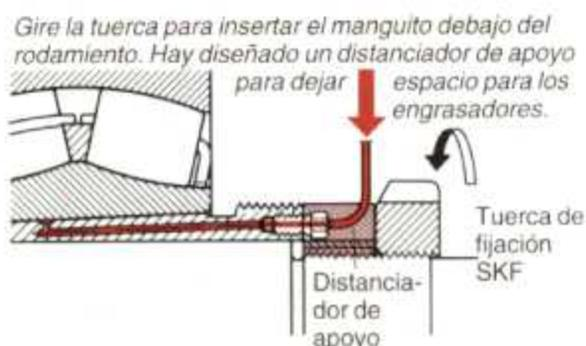
Sólo es posible insertar el manguito debajo del rodamiento mediante una tuerca si se coloca un distanciador entre el manguito y la tuerca.
