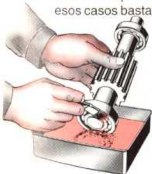
exteriores. El rodamiento deberá reemplazarse si parece sufrir algún daño.
