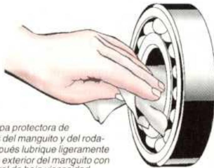
*Limpie la capa protectora de los agujeros del manguito y del rodamiento, después lubrique ligeramente la superficie exterior del manguito con aceite mineral de baja viscosidad.*
