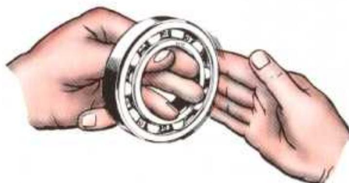
*Inspeccione que en los rodamientos no se presentan grietas, decoloraciones, arañazos y marcas por sobrecarga. Haga girar rápidamente el aro exterior del rodamiento ya limpio y escuche para tratar de detectar ruidos sospechosos.*
