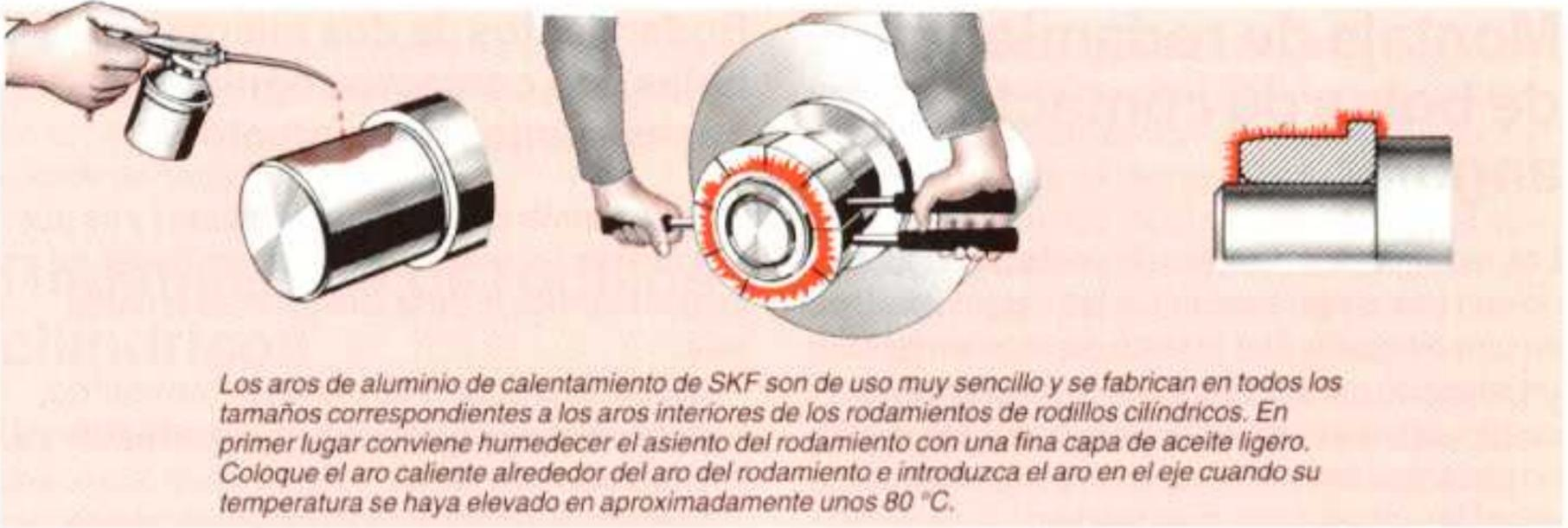
Los aros de aluminio de calentamiento de SKF son de uso muy sencillo y se fabrican en todos los tamaños correspondientes a los aros interiores de los rodamientos de rodillos cilíndricos. En primer lugar conviene humedecer el asiento del rodamiento con una fina capa de aceite ligero. Coloque el aro caliente alrededor del aro del rodamiento e introduzca el aro en el eje cuando su temperatura se haya elevado en aproximadamente unos 80 °C.
