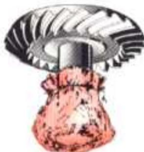
Si esto no es posible, recubra los rodamientos cuando se encuentren al descubierto. Si no dispone de hojas de papel encerado o láminas de plástico, utilice una gasa limpia que no deje pelusas. Enrolle el material protector con fuerza para evitar la entrada de contaminantes.
