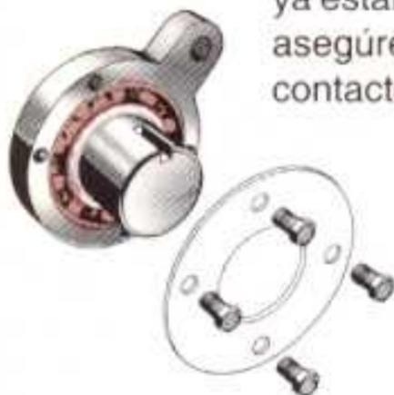
*Para cubrir el asiento del rodamiento en el alojamiento se pueden utilizar discos hechos de cartón, metal o madera. Utilice tornillos para sujetar esos discos.*
