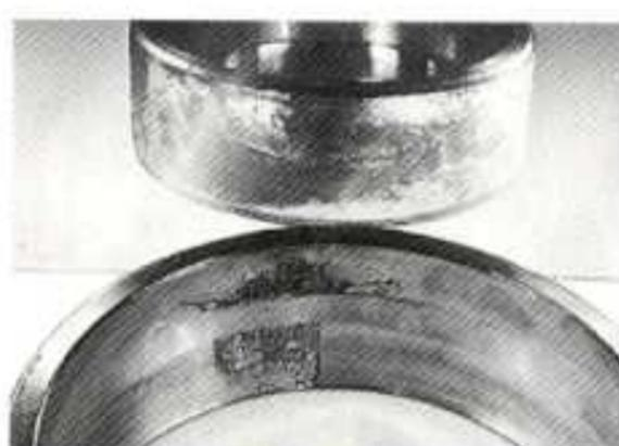
**Desconchado producida por corrosión por contacto**
