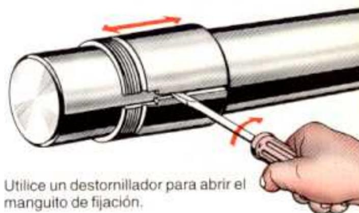
Utilice un destornillador para abrir el manguito de fijación.
