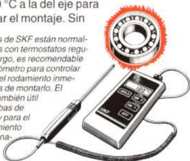
embargo, nunca caliente un rodamiento a una temperatura superior a los 125 °C, ya que se pueden producir transformaciones metalúrgicas en el material y producirse variaciones de diámetro o dureza. Debe evitarse que se produzcan sobrecalentamientos locales. Cuando se utilice un dispositivo de calentamiento, habrá de utilizarse un termómetro para comprobar la temperatura del rodamiento.
