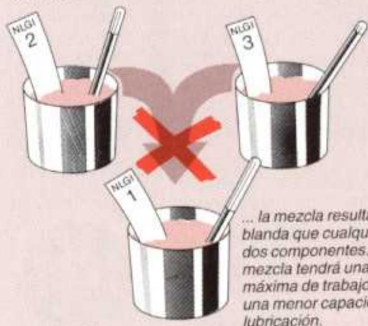
*... la mezcla resultante es más blanda que cualquiera de sus dos componentes. Además, la mezcla tendrá una temperatura máxima de trabajo más baja y una menor capacidad de lubricación.*
