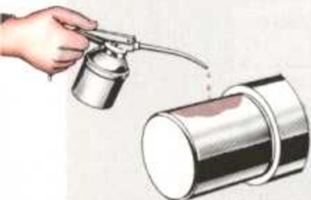
Lubrique la rosca de la tuerca y la cara de ésta que se apoyará en el rodamiento con pasta de bisulfuro de molibdeno o un lubricante similar y aplique una capa de aceite fino en la superficie en el eje y la superficie exterior del manguito.
