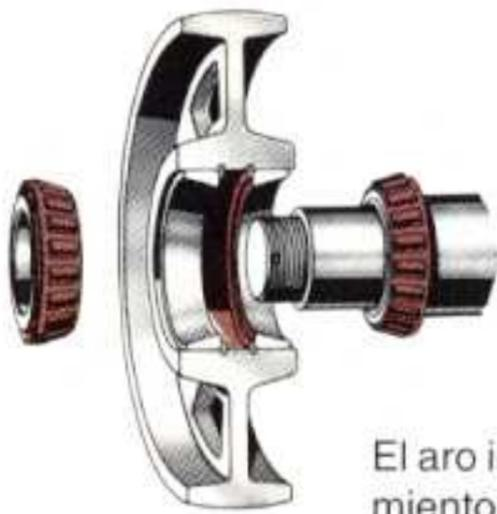
El aro interior del rodamiento interno, junto con el conjunto de rodillos y jaula, debe montarse presionando sobre el soporte. Rellene con grasa el espacio existente entre los rodillos de ambos rodamientos. Coloque la rueda en su lugar, y monte el aro interior del rodamiento externo, junto con su conjunto de jaula y rodillos.
