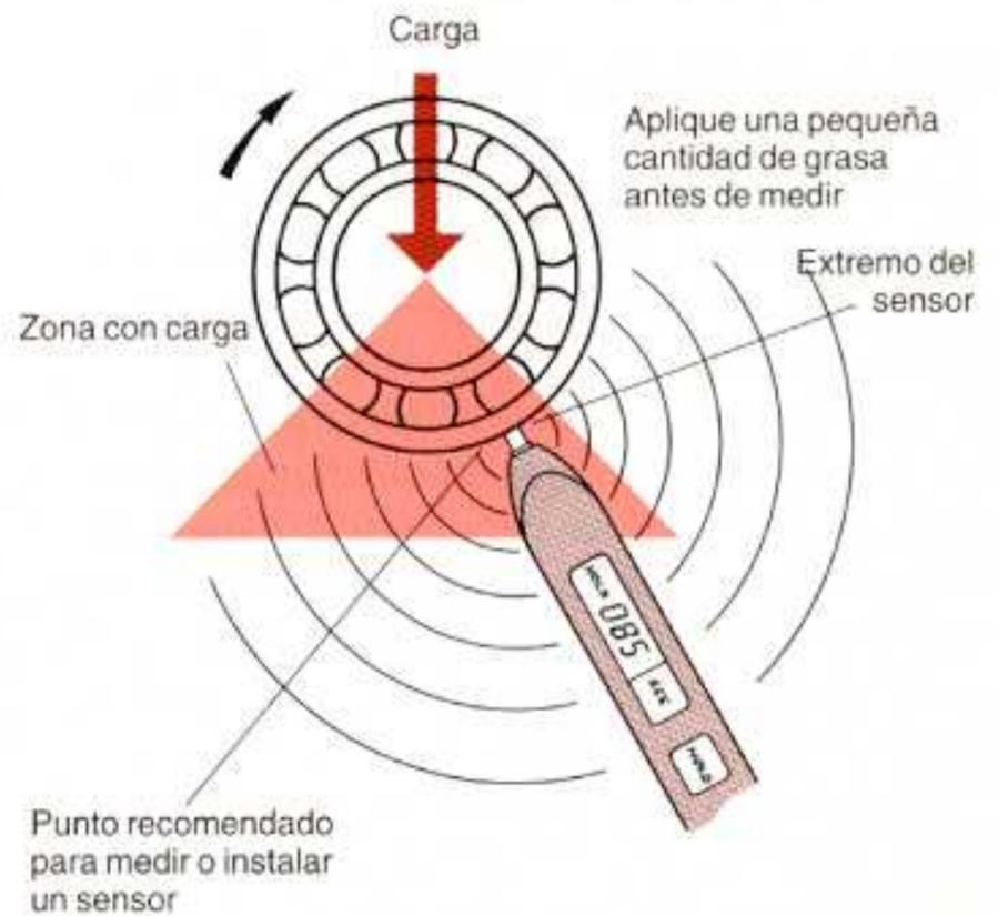
*Coloque el extremo del sensor del lápiz en la zona con carga del rodamiento, perpendicular a la superficie del soporte. La presión aplicada debe ser entre 5 y 20 N.*
