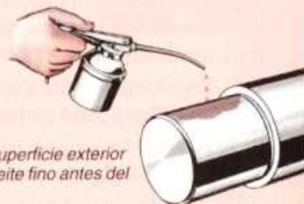
Lubrique el eje y la superficie exterior del manguito con aceite fino antes del montaje.
