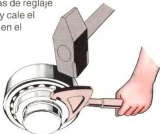
Los rodamientos de rodillos a rótula de tamaño pequeño a mediano se pueden montar sobre el manguito de fijación por medio de una tuerca de fijación y una llave.
