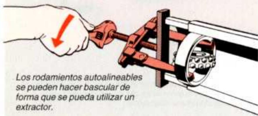
Los rodamientos autoalineables se pueden hacer bascular de forma que se pueda utilizar un extractor.
