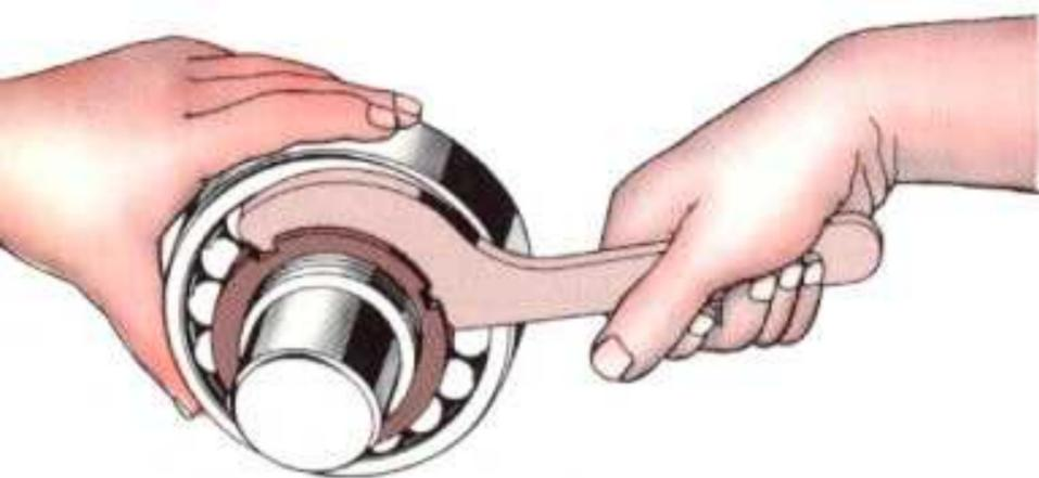
*En un eje roscado, también se puede usar una tuerca de fijación para el montaje. Apriete la tuerca con una llave de gancho.*
