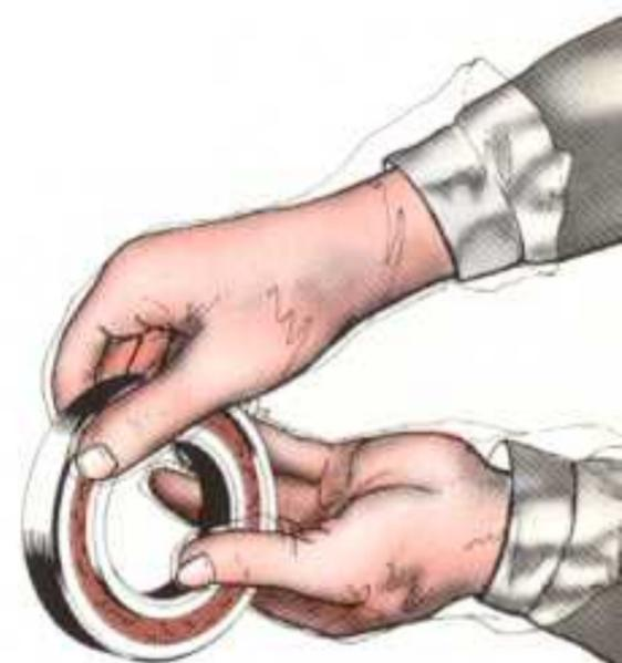
*Un rodamiento sin daños se puede volver a montar sin que suponga ningún riesgo. Engrase el rodamiento inmediatamente después de concluir su limpieza para evitar oxidaciones, hágalo girar lentamente al mismo tiempo.*
